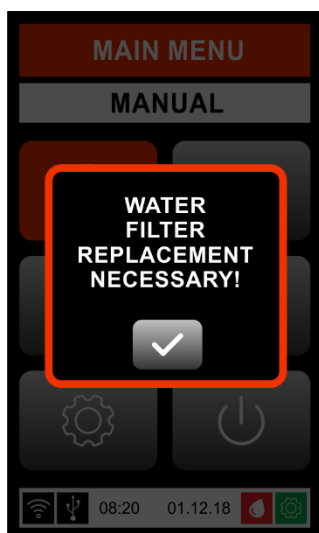
Рисунок 20: Требуется срочная замена фильтра для воды
