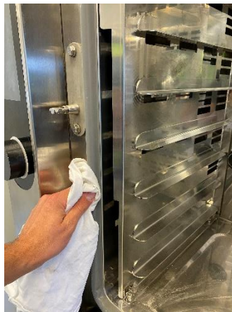
Рисунок 56: Очистка прокладки дверцы
