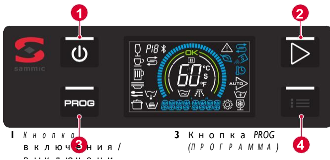
Рис. 2: Панель управления и кнопки со светодиодами
