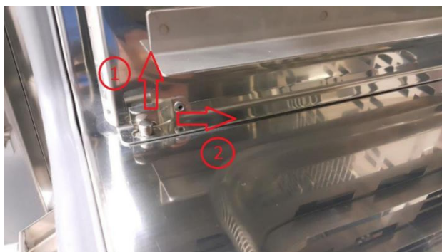
Рисунок 57: Снятие держателей противней
