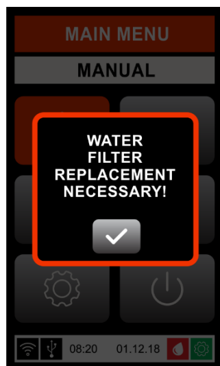
Рисунок 18: Требуется замена фильтра воды
