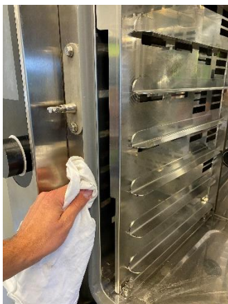
Рисунок 56: Очистка уплотнителя дверцы
